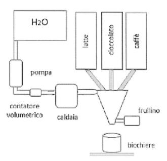
Le polveri di latte, cioccolato, caffè e l'acqua preventivamente riscaldata tramite caldaia vengono convogliate in un apposito raccoglitore di forma conica dove vengono miscelati con un "frullino", azionato da un motore a 24 Vdc, durante l'erogazione della bevanda scelta.
